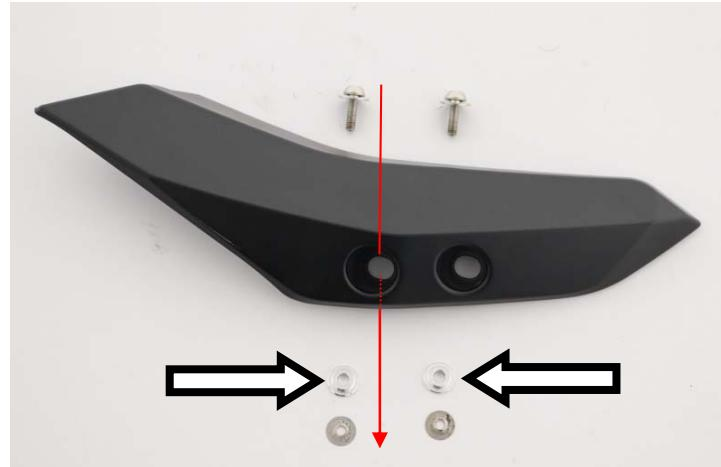
**IT** · Sostituire nella protezione del collettore i bussolotti ed i gommini originali con i soli bussolotti forniti
