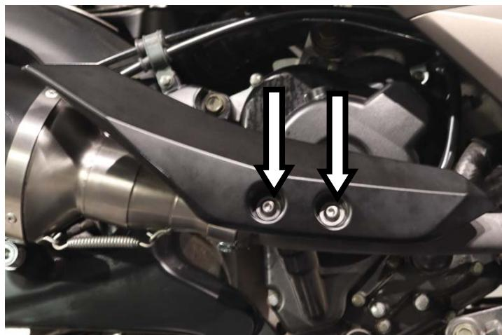
**IT** · Montare la protezione utilizzando gli spessori forniti, le due viti e le quattro rondelle originali
