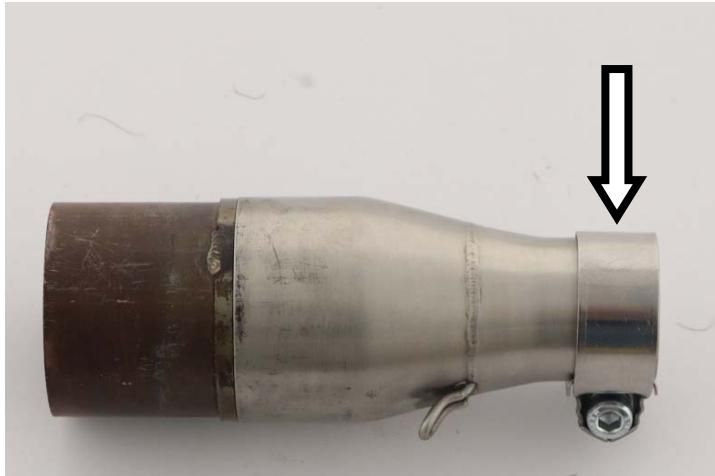
**IT** · Posizionare la fascetta di serraggio nell'innesto del raccordo
