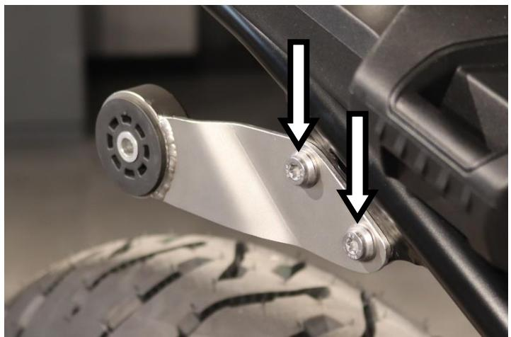
**IT** · Sostituire la staffa di fissaggio originale con quella fornita
