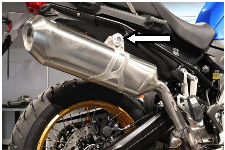
**IT** · Allentare la fascetta, svitare la vite di fissaggio e rimuovere il terminale originale
