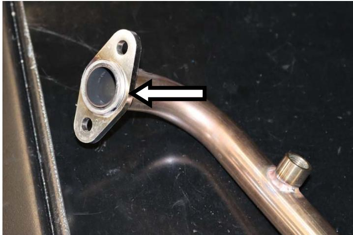
**IT** · Posizionare la guarnizione originale nel collettore Arrow
