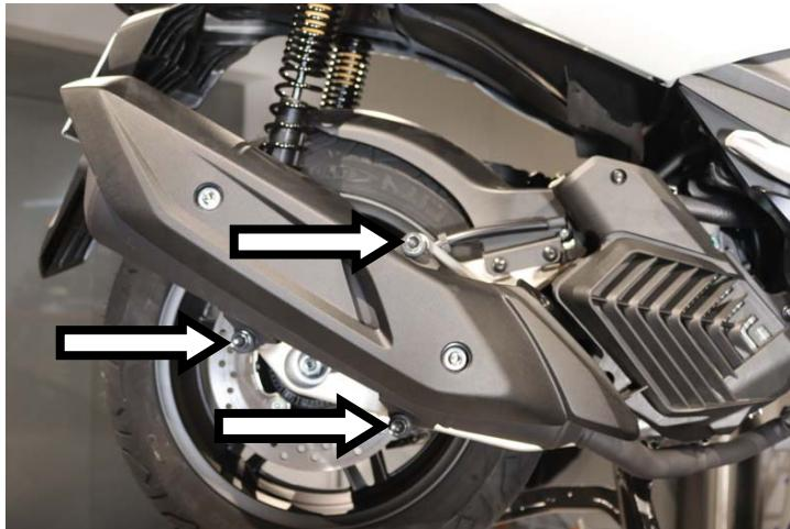
**IT** · Svitare le tre viti di fissaggio e rimuovere lo scarico originale
