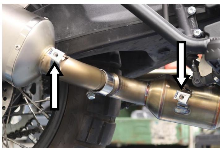
**IT** · Posizionare le due clip nell'attacco del raccordo e del terminale
