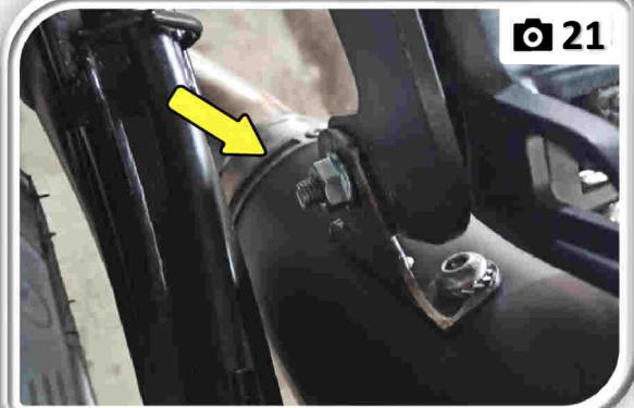
**IT** Montare il silenziatore con la staffa 50.SS.1264.0 e fissarlo alla staffa 50.SS.840.0 con i componenti in dotazione.
