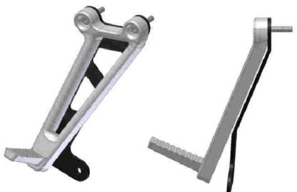
**IT** Rimuovere la pedana passeggero originale, posizionare la staffa 50.SS.840.0 sotto di essa e riavvitare i due componenti tramite le viti originali. La staffa 50.SS.840.0 servirà per il fissaggio dei terminali MIVV.
