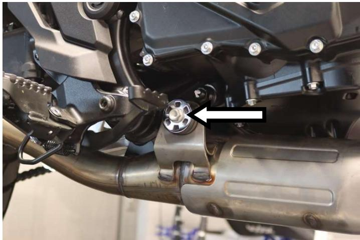
**IT** · Svitare la vite di fissaggio e rimuovere i collettori
