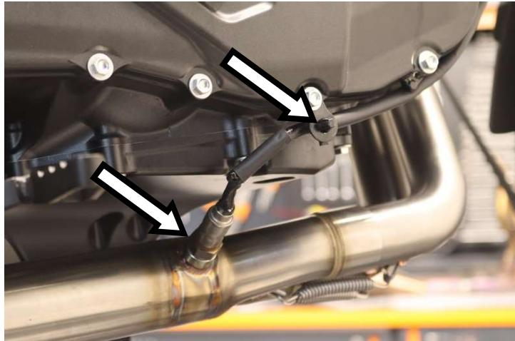
**IT** · Avvitare la sonda lambda e fissare il cavo al supporto
