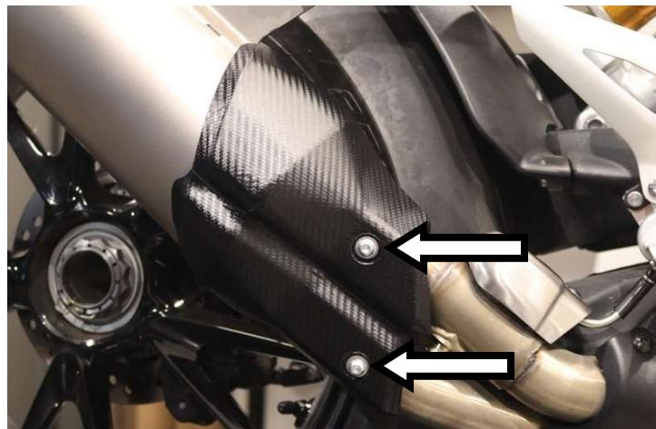
**IT** · Montare la protezione, fissandola con le viti come mostrato in foto
