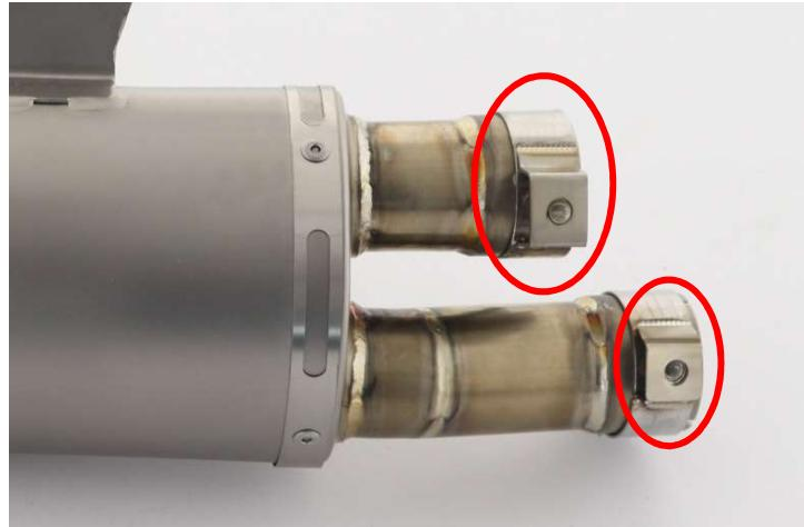
**IT** · Posizionare le fascette fornite a corredo con la protezione come mostrato nelle foto (la gabbietta grande va nell'innesto superiore, la piccola nell'inferiore)
