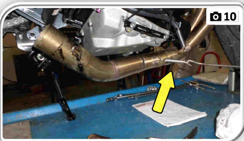
**IT** Assemblare il tubo 9773AK044S2C ( biforcazione ), fissandolo con le molle in dotazione. (Foto 8-9-10)
