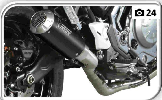
**IT** Fissare il terminale MK3 con la staffa e la viteria in dotazione. (Foto 23-24)
