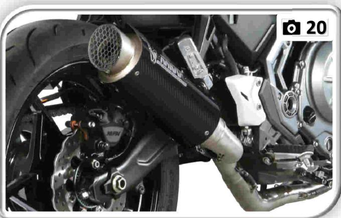
**IT** Fissare il terminale GP PRO con la staffa e la viteria in dotazione. (Foto 19-20)
