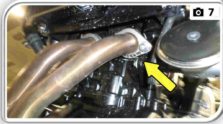
**IT** Fissare i collettori Mivv con le flange ed i dadi in dotazione. Serrare solo dopo aver terminato il montaggio.
