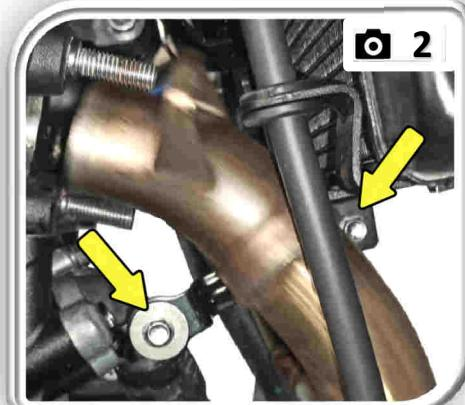
**IT** Svitare e rimuovere i dadi di fissaggio dai tubi collettori. Per facilitare la rimozione dei tubi collettori, svitare la staffa del radiatore.
