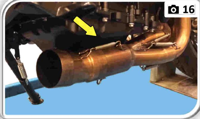
**IT** Montare il tubo di raccordo finale ( cod. 9773T022SDRXE ) e fissarlo nella parte superiore con la molla in dotazione.
