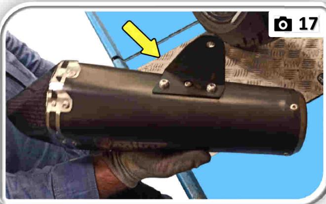
**IT** Assemblare il silenziatore con la staffa 50.SS.1323.0 e con la viteria in dotazione.
