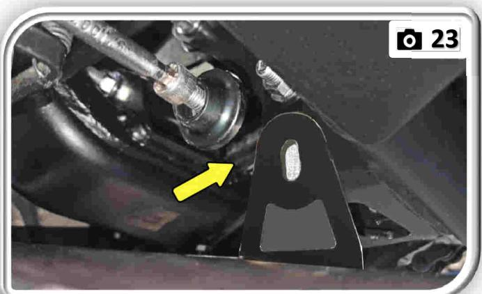
**IT** Fissare il silenziatore al telaio con vite e rondella.
