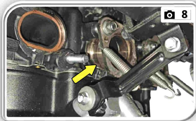
**IT** Assemblare i tubi collettori utilizzando boccole, flange, molle e dadi originali. Fare attenzione al verso della boccola.
