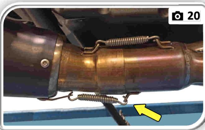
**IT** Fissare il silenziatore nella parte inferiore con la molla in dotazione.
