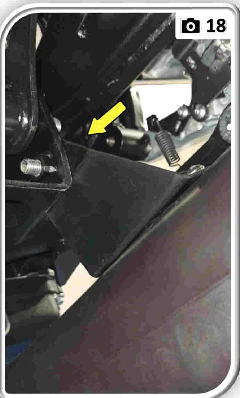
**IT** Inserire il silenziatore sul tubo di raccordo e fissarlo al telaio con vite e rondella.
