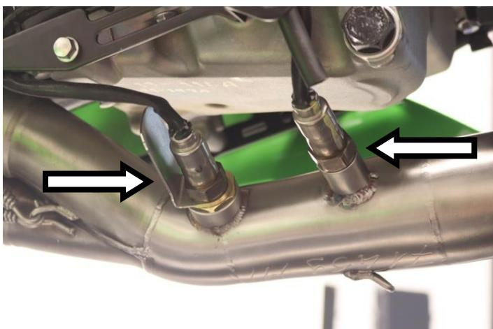
**IT** · Avvitare l'adattatore M18/M12 (versioni Euro5+), la protezione per la sonda lambda ed avvitare la sonda lambda (anteriore). Avvitare la sonda lambda posteriore.
