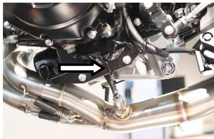
**IT** · Fissare il cavo della lambda alla staffa mediante fascetta a strappo fornita
