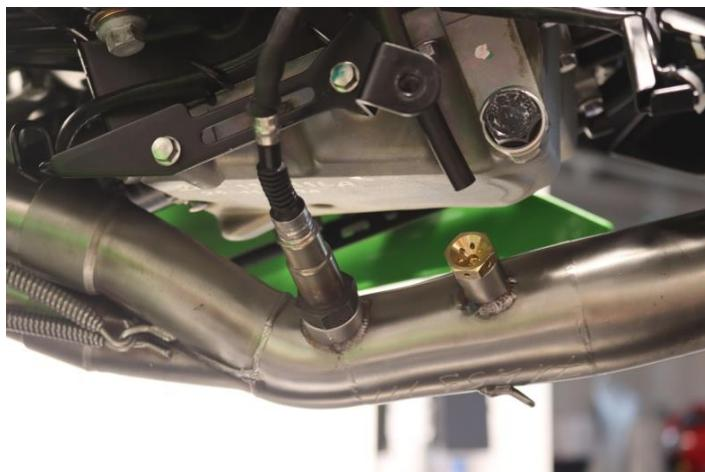
**IT** · Avvitare la sonda lambda nell'attacco del raggruppamento (versioni Euro4) e montare il tappo in ottone come mostrato in foto
