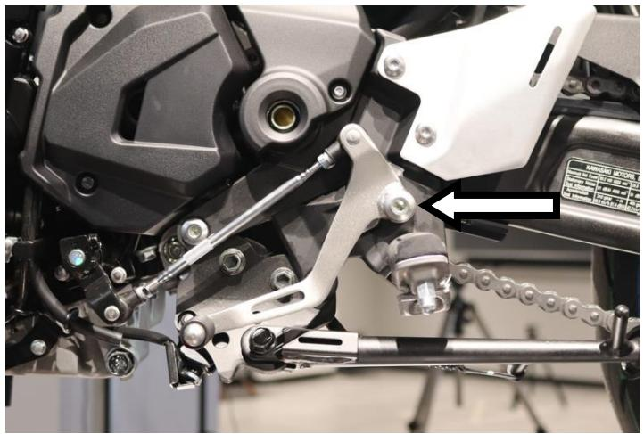
**IT** · Rimontare il pedalino del cambio come in origine
