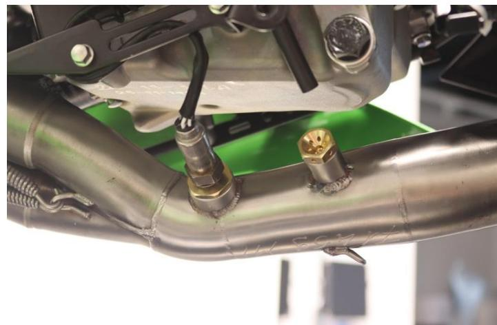
**IT** · Avvitare riduzione e sonda lambda nell'attacco del raggruppamento (versioni Euro5) e montare il tappo in ottone come mostrato in foto
