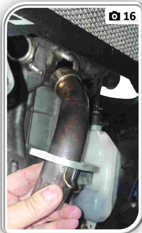
**IT** Inserire le guarnizioni originali e montare i due collettori A e B fissandoli con i dadi originali. Serrare solo dopo aver ultimato tutto il montaggio.
