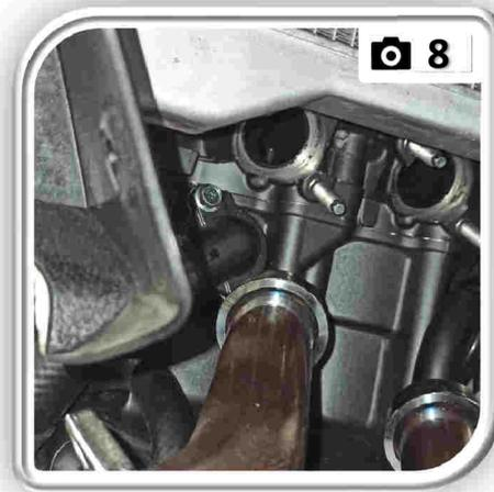
**IT** Svitare e rimuovere i dadi di fissaggio dai tubi collettori. Conservare le guarnizioni originali per il successivo montaggio dei collettori MIVV.
