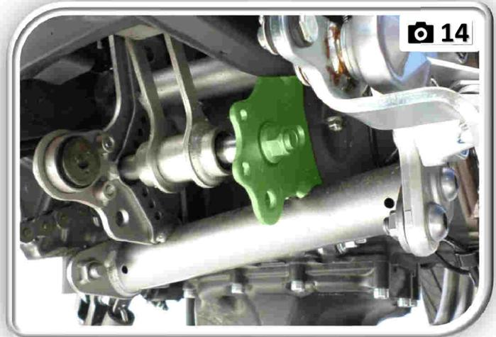
**IT** Rimuovere SOLO il supporto marmitta destro, svitando le 2 viti che lo fissano al telaio della moto.
