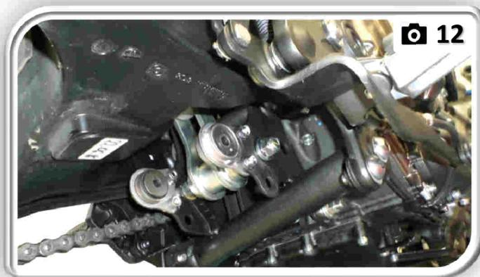
**IT** Rimuovere le due viti laterali che fissano lo scarico originale ai 2 supporti di forma rotonda. Rimuovere lo scarico originale.
